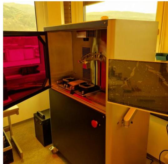
©PCCL; Der entwickelte Multi-Material DLP Drucker mit beweglicher Harzbecken-Plattform und einfacher Reinigungsstation (1. Generation)
